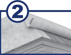
Preklapanje na sljemenu i na rubovima krova mora biti najmanje 20 cm. Vrhni razvitek membrane mora presegati slemenšće in strešni vogal za vsaj 20 cm.
