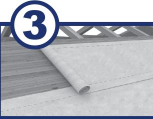
Prilikom postavljanja membrane **Ursa** potrebno je primjenjivati 15 cm preklapanja (mjesto preklapanja na membrani označeno je linjom). U slučaju kada je nagib krova manji od 22°, preklapanje mora iznositi najmanje 20 cm.
